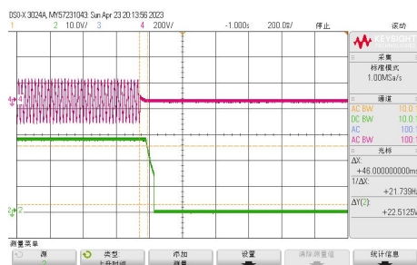
Vin=115VAC 满载关机（掉电保持 46ms）
