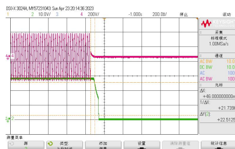
Vin=230VAC 满载关机（掉电保持 46ms）
