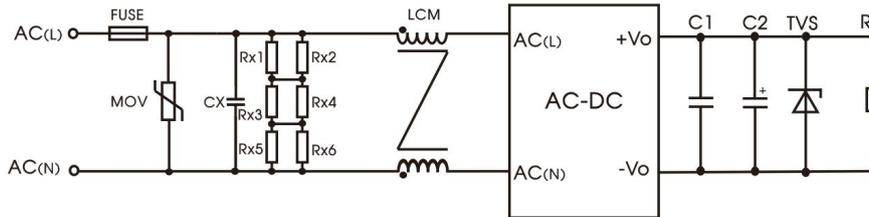
图 2: EMC 更高要求推荐电路
